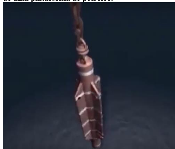
Figura 2 - aplicação do olhal torpedo no içamento de uma plataforma de petróleo.
