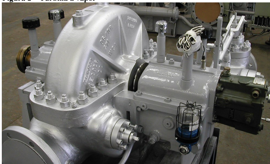
Figura 2 – Turbina a vapor
