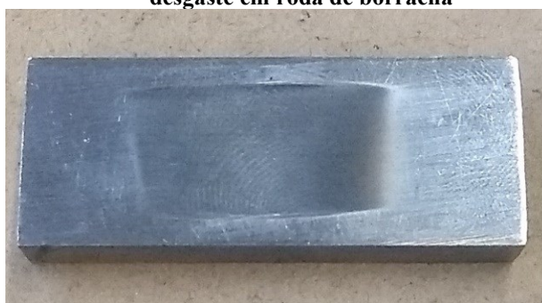
Fotografia 2 – Aspecto da amostra S.T.T. após ensaio de desgaste em roda de borracha
