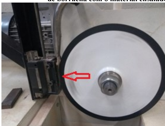
Fotografia 1 – Detalhe do contato da areia e da roda de borracha com o material ensaiado
