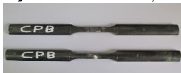
Fotografia 2 - Amostras de Ensaios de Tração CPB.
