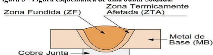
Figura 3 - Figura esquemática de uma Junta Soldada.
