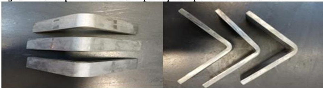
Figura 2 - Vista superior e lateral dos corpos de prova após ensaio de dobramento
