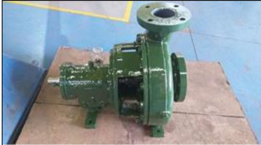
Fotografia 10- bomba já montada e finalizada com pintura original de fábrica
