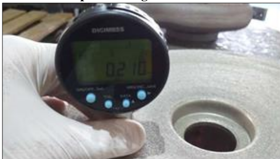
Fotografia 6 - voluta da bomba jateada e sendo medida com aparelho rugosímetro
