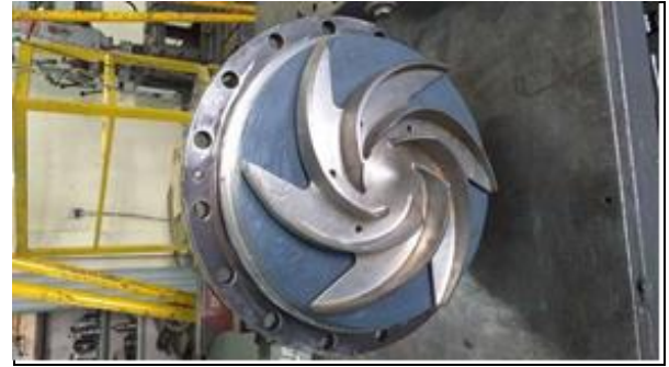
Fotografia 09 - bomba montada com tampa revestida com polímero e rotor
