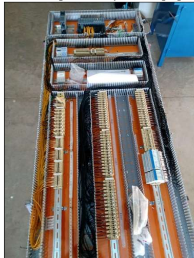
Fotografia 4 - chapa com layout e equipamentos
