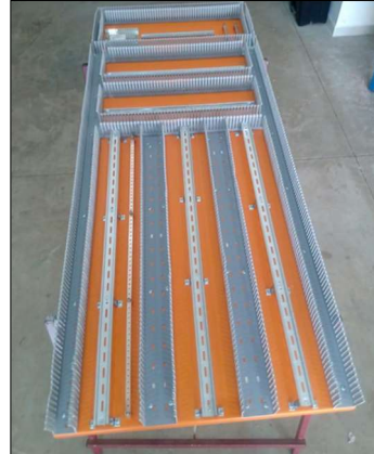
Fotografia 3 - chapa de montagem com o layout
