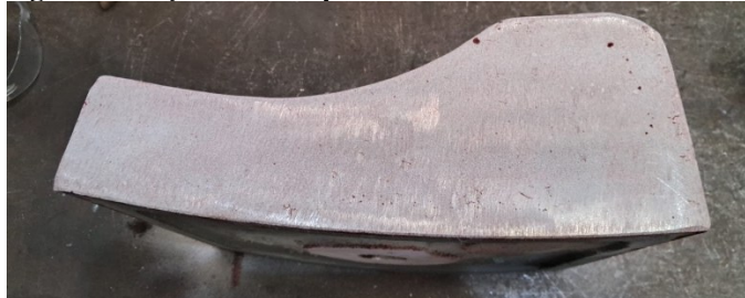
Figura 1 - Peça fundida após retirada dos canais e massalotes
